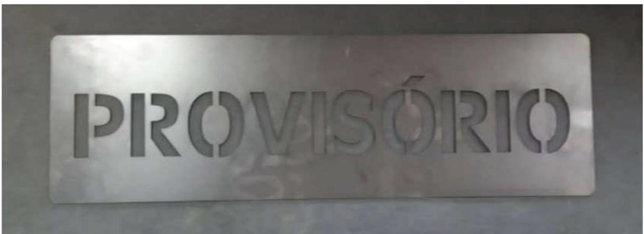
**Figura 1 - Exemplo de gabarito para marcação de recomposição provisória.**
