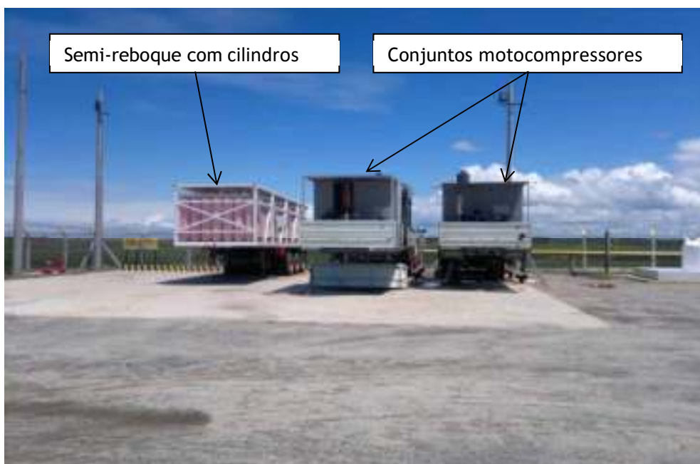
Figura 5 - Semi-reboque e conjuntos motocompressores na Estação de Compressão
